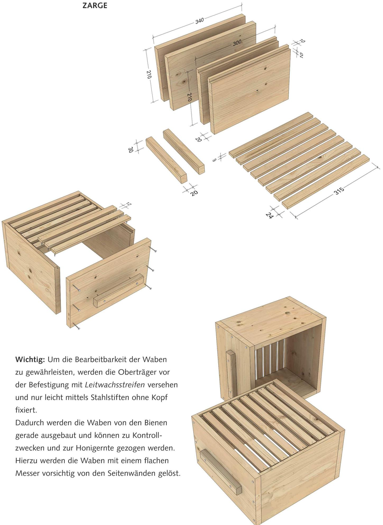
**Wichtig:** Um die Bearbeitbarkeit der Waben zu gewährleisten, werden die Oberträger vor der Befestigung mit *Leitwachsstreifen* versehen und nur leicht mittels Stahlstiften ohne Kopf fixiert.
